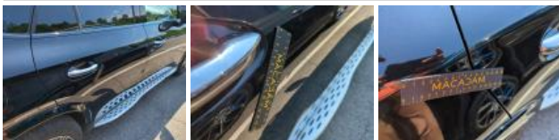
Modanatura sottoporta Dx, Rotto, Sostituire
