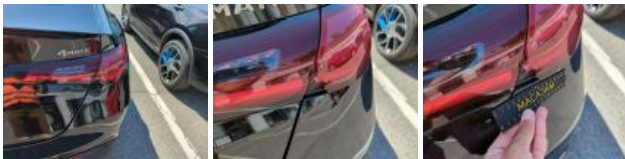
Fanale portellone post. Dx, Rotto, Sostituire
